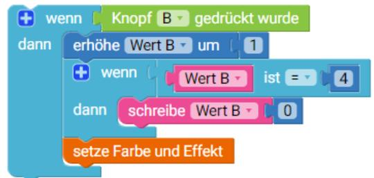
**7** Als Teil der Funktion **setze Farbe und Effekt** überprüfe den Wert von **Wert B** und schalte die RGB LED entsprechend mit einem anderen Effekt ein.
